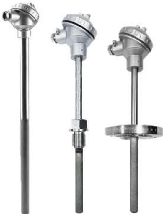
TAR 新研制的新型耐磨热电偶（阻）采用等离子喷涂技术、高铬铸铁和 K 氏合金不同材料制成的耐磨保护管，使耐磨度大大提高，延长了使用寿命，并扩大了测温范围，适用于电厂循环硫化床锅炉、磨煤机和水泥厂、冶炼厂等对温度传感器保护管磨损严重的场合。
