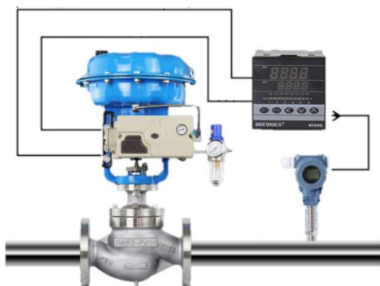
1、气动调节阀 2、压力传感器 3、PID控制器
