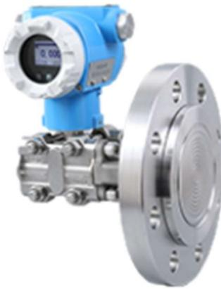
PTC-LT 型法兰式液位变送器可对各种密封容器介质的压力进行精确的测量, 可测量液体, 气体, 蒸汽。变送器应用了先进的数字技术及频率相移健控 (FSK) 技术, 提高了整机性能及可靠性, 方便了现场和控制室之间的连接。除具有远程通讯能力外, 它还具有本机调量程, 调零点按钮, 便于现场安装后的就地调整。电子部件采用先进的集成电路和表面安装工艺, 具有通信、查询、调试、组态等功能, 广泛应用于石油、化工、电力、冶金、钢铁、环保水处理、锂电池新能源等行业对密闭压力或者敞口容器或者储罐内的液体的液位压力的常压下的测量。
